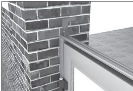
Просверлите профиль «крышка столба» в местах стыка профиля «крышка столба» и специальных пазов профиля «корпус столба».
