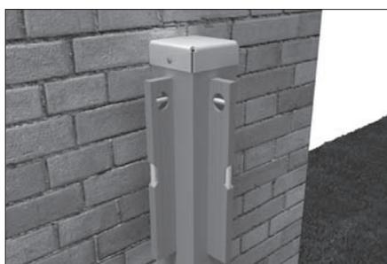
Строительным уровнем проверьте вертикальность расположения 2 перпендикулярных плоскостей каждого столба. Выставьте столбы относительно друг друга в одной плоскости с помощью уровней.
