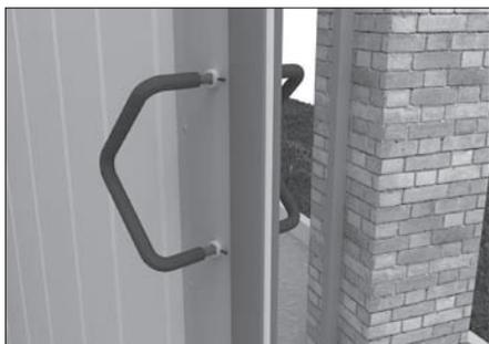
С помощью воротка попеременно закрутите оба винта по 3'5 мм за прием. Так как винты и ручки имеют правую и левую резьбу, то при вкручивании винта в первую ручку происходит одновременное вкручивание другого конца винта во вторую ручку.
