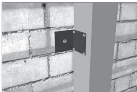
Прикрепите кронштейны крепления к столбу к навесным столбам при помощи 4 саморезов по металлу и к столбам проема с помощью анкерных болтов.
