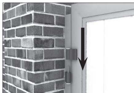
Поднесите створку к столбу. С помощью подкладок обеспечьте горизонтальность положения створки и необходимый просвет. Установите полотно калитки на петли.
