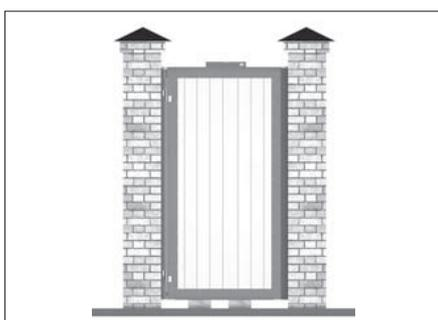
Поднесите створку к столбу. С помощью подкладок обеспечьте горизонтальность положения створки и необходимый просвет.
