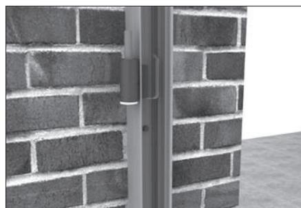
Закрепите профиль «корпус столба» к притолоке при помощи саморезов.
