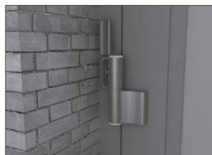
Закрепите петли на монтажных столбах при помощи винтов.
